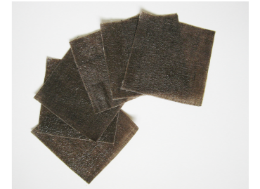
Unsere Probestücke: Mischungsverhältnisse resultierten in verschiedenen Oberflächen
